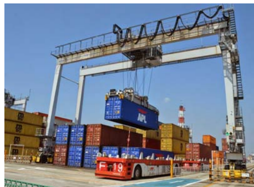
遠隔自働 RTG と AGV の稼働状況 (名古屋港管理組合提供)
